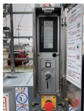
7 操作盤(タッチパネル) 安全確認ボタン 非常停止ボタン(赤)
