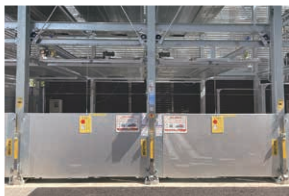
1 ゲート | 人や車の侵入を防止するため装置前面に各連ゲートを設置しています。
